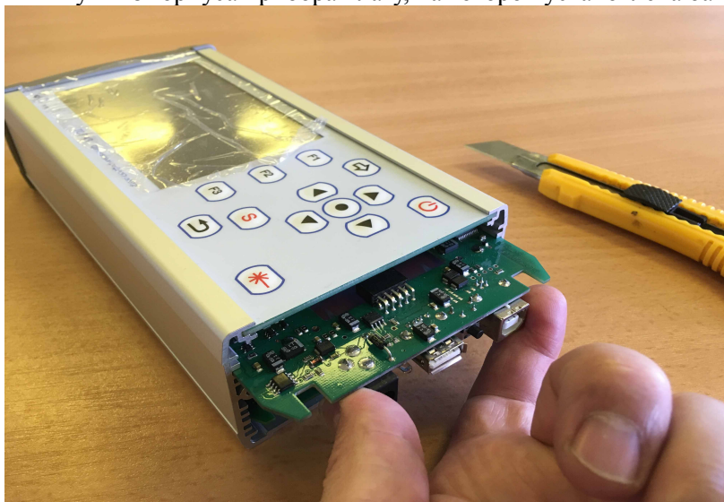
Рис.7. Для вытаскивания платы можно взяться двумя пальцами за разъемы питания и USB (как показано на рисунке).
