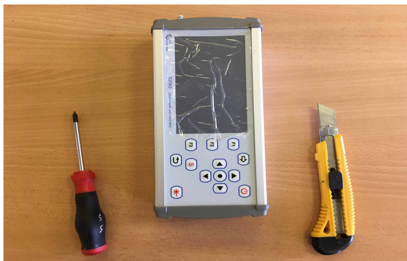
Рис.2. Для снятия крышки нужны крестовая отвертка и нож с острым плоским концом.
