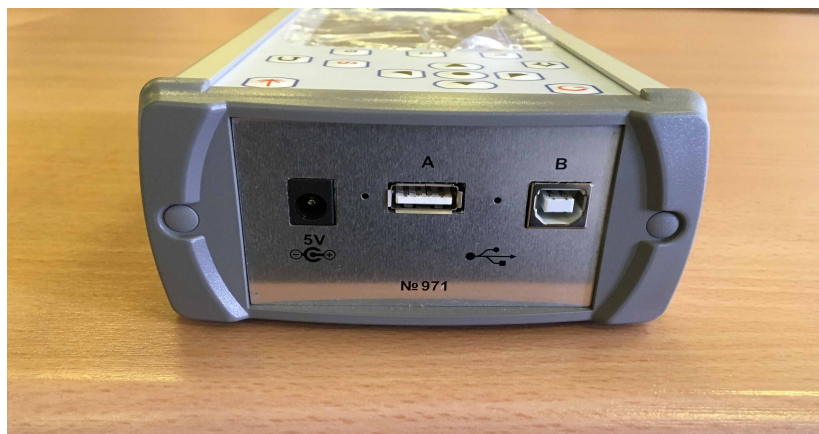
Рис.1. Вид боковой крышки прибора с разъемами питания и USB.
