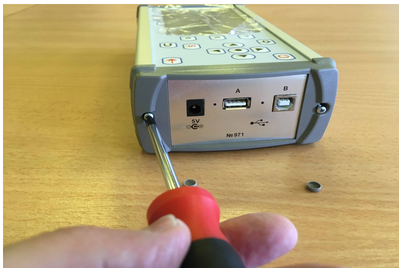
Рис.5. Вывернуть саморезы и снять крышку.
