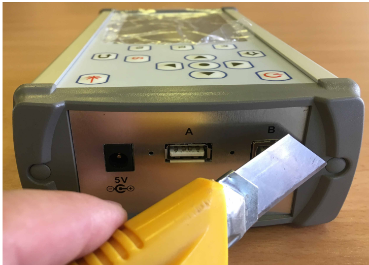
Рис.3. Снять заглушки крепежных винтов, аккуратно поддев их лезвием ножа.
