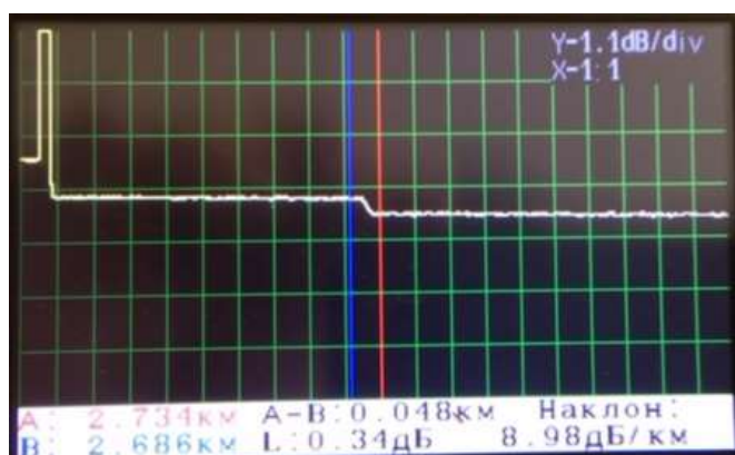
Рис. 15 Измерение затухания на неоднородности
