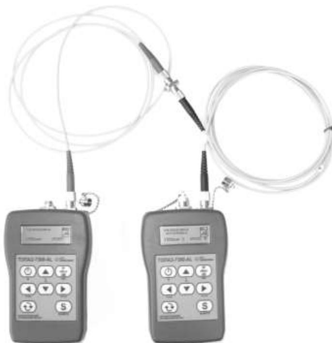
Рис.20. Калибровка приборов
