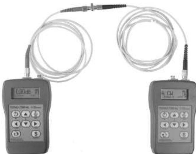
Рис.6. Измерение опорного уровня
