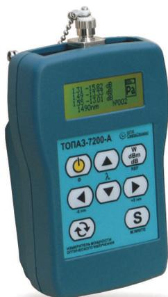
Измерители оптической мощности серии ТОПА3-7200-А являются универсальным средством для тестирования и паспортизации оптических линий связи всех типов, в том числе PON, CWDM, DWDM и др.
