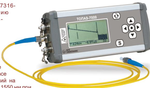
Наличие режимов автоопределения длины волны во встроенных измерителе мощности и источнике значительно повышают производительность труда при инсталляции и сдаче-приемке PON. Совместимость с тестерами серии «ТОПАЗ-7000-A/AL» в режиме измерения затухания позволяет оптимизировать затраты на оборудование.
