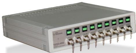
Источник оптического излучения «Топаз-4002» предназначен для тестирования CWDM систем и отдельных их элементов. Он может применяться как в процессе производства CWDM-компонентов, так и при строительстве и эксплуатации оптоволоконных линий, использующих технологию уплотнения CWDM.
