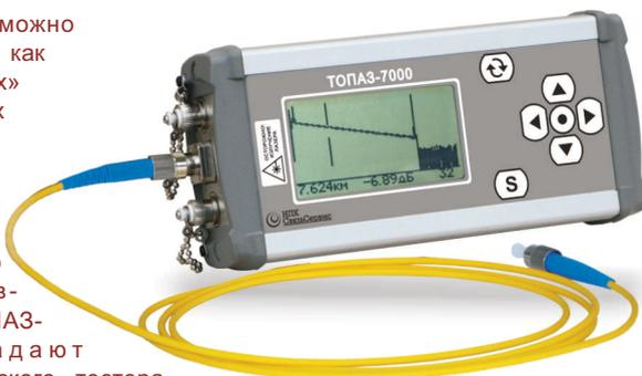
Наличие в приборе излучателя с длиной волны 1625 нм позволяет тестировать работающие линии связи без отключения сигнала. В комплекте с прибором поставляется защитный фильтр, обеспечивающий изоляцию тестового сигнала рефлектометра от рабочих сигналов линии. Конструкция фильтра позволяет подключать рефлектометр к линии для работы в режиме мониторинга ее целостности.
