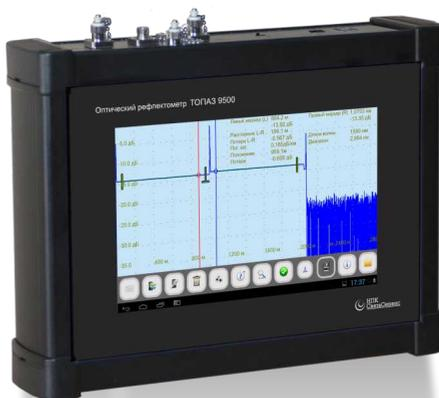
Семейство приборов Топаз-9500/9600 идеально подходит для тестирования оптических сетей доступа, пассивных сетей (PON) и зонавых магистральных сетей.
