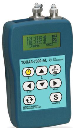
Комплект автоматических оптических тестеров серии **ТОПА3-7300-AL** позволяет выполнить двухсторонние измерения затухания, возвратных потерь с двух сторон и длины линии всего за 20 секунд. При этом измерения проводятся на трёх длинах волн.
