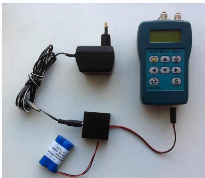
Рис. 3. Способ подключения ВЗУ-1
