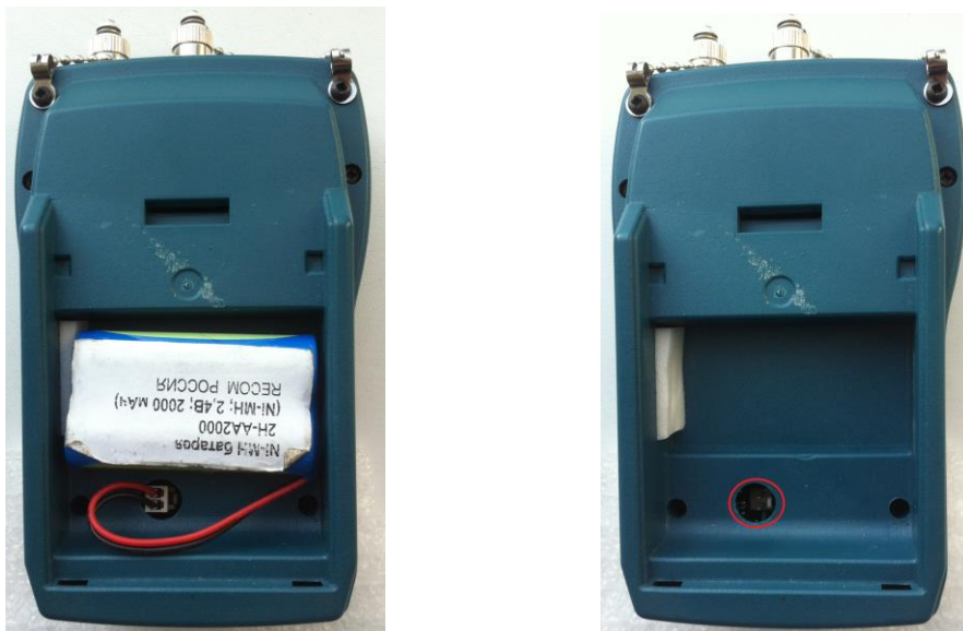
Рис.1. Размещение и подключение аккумуляторной батареи в батарейном отсеке оптического тестера серии «Топаз-7000».
