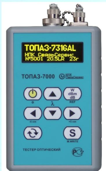
Они имеют семь режимов работы и могут использоваться как измеритель оптической мощности, источник оптического излучения, измеритель обратного отражения (возвратных потерь, ORL) и измеритель длины линии или расстояния до обрыва. Два автоматизированных режима позволяют наблюдать на дисплее затухание линии для 3-х длин волн одновременно или с помощью пары тестеров выполнить двухсторонние измерения затухания линии, возвратных потерь и длины линии для 3-х длин волн за один цикл.
