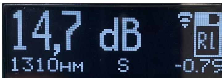
Рис.32. Режим RL (коннектор P2 типа UPC)
