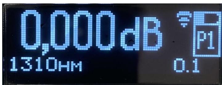
Рис.8. Вид индикатора после установки опорного значения в режиме P1
