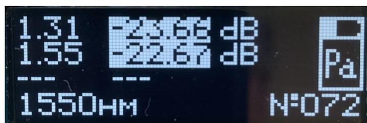
Рис.13. Индикация превышения пороговых значений
