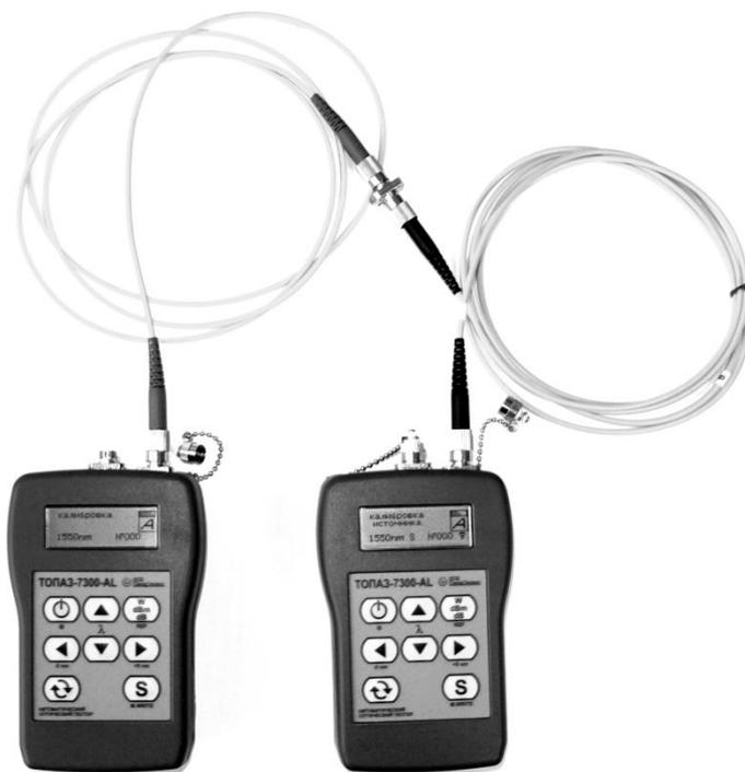
Рис.20. Калибровка приборов
