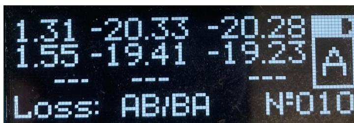
Рис. 24. Результаты измерения затухания
