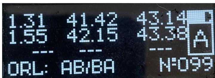
Рис.25. Результаты измерения обратного отражения
