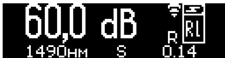
Рис.34. Результат компенсации собственных отражений.
