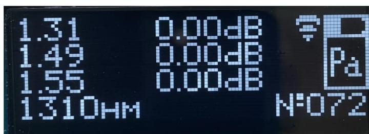
Рис.11. Режим Pa. Индикатор после установки опорных уровней.
