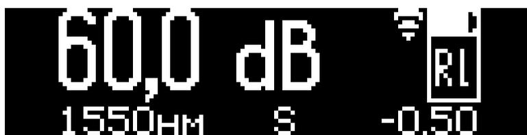
Рис.33. Режим RL (коннектор P2 типа APC)
