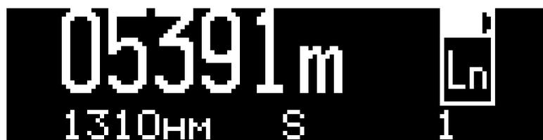
Рис.31. Режим Ln. Результат измерения длины при плохом вводе измерительного сигнала (второй результат –отражение в конце линии)
