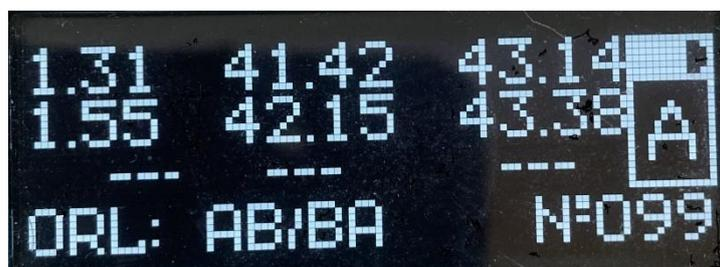
Рис.18. Результат измерения возвратных потерь
