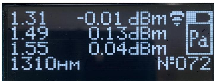
Рис.10. Режим Pa. Показания в dBm
