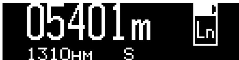
Рис.29. Режим Ln. Результат измерения длины
