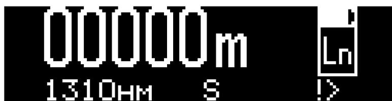
Рис.30. Режим Ln. Результат измерения длины при плохом вводе измерительного сигнала (первый результат – отражение на входе)
