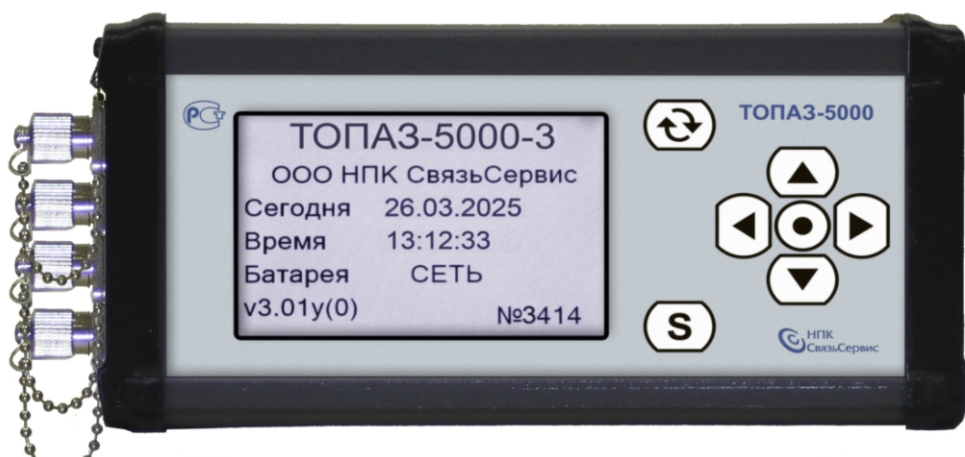
Рис.1. Внешний вид аттенюатора (лицевая панель)
