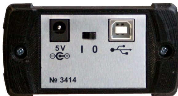
Рис.3. Внешний вид аттенюатора (боковая панель с разъемами питания и USB, выключателем питания и серийным номером)
