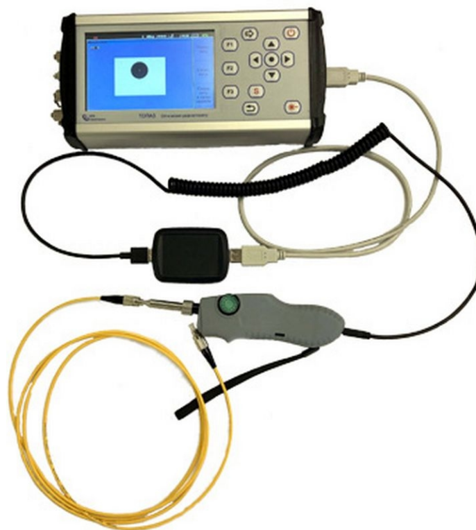
Рис.ПЗ-2. Подключение Волоконного микроскопа к рефлектометру «Топаз-9400»
