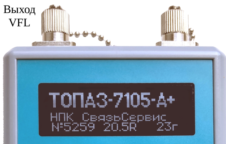
Рис. 1. Верхняя часть прибора с опцией «Источник видимого излучения». Оптические разъемы и дисплей.
