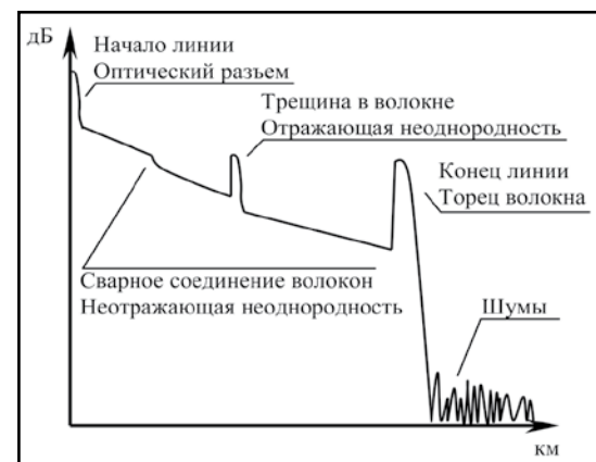
Рис. 3. Типичная рефлектограмма линии
