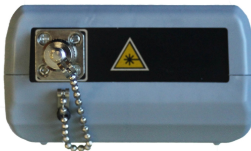
Рис. 3. Вид верхней панели модуля оптического телефона
