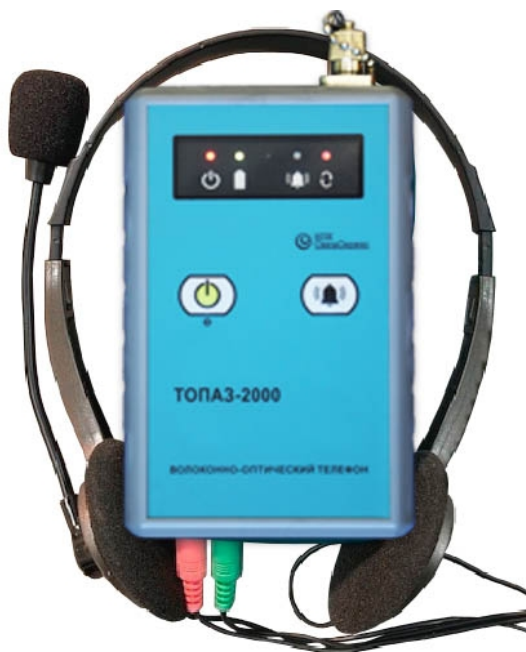
Рис. 1. Внешний вид модуля оптического телефона с гарнитурой
