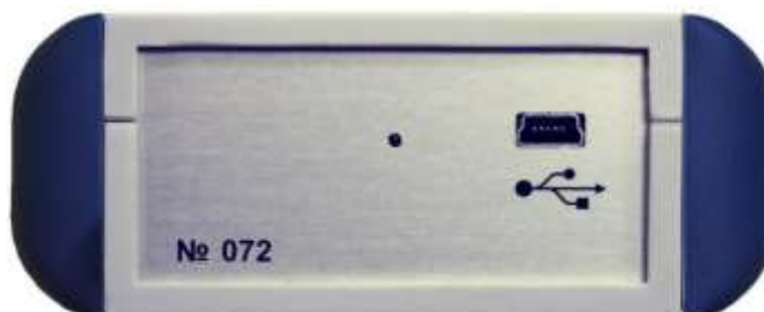
Рис.3. Внешний вид аттенюатора (боковая панель с разъемом USB, серийным номером и индикатором заряда батареи)
