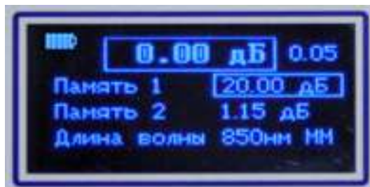
Рис.4 Индикатор аттенюатора в рабочем режиме
