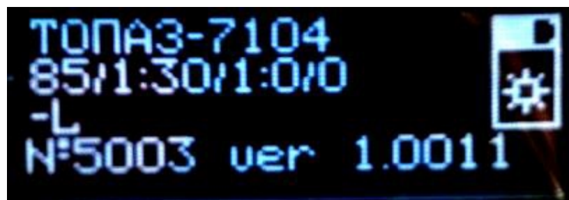
Рис.2п. Отображение «Информации о приборе» в режиме «Установки»
