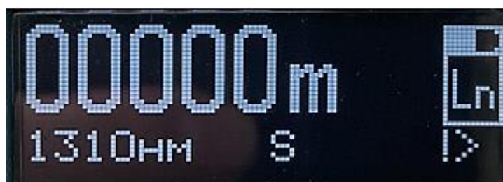
Рис.29. Режим Ln. Результат измерения длины при плохом вводе измерительного сигнала (первый результат – отражение на входе)
