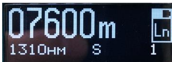
Рис.30. Режим Ln. Результат измерения длины при плохом вводе измерительного сигнала (второй результат –отражение в конце линии)
