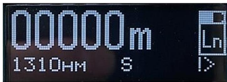
Рис.8.3. Режим Ln. Результат измерения длины при плохом вводе измерительного сигнала (первый результат – отражение на входе)
