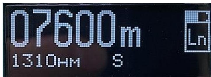
Рис.8.2. Режим Ln. Результат измерения длины
