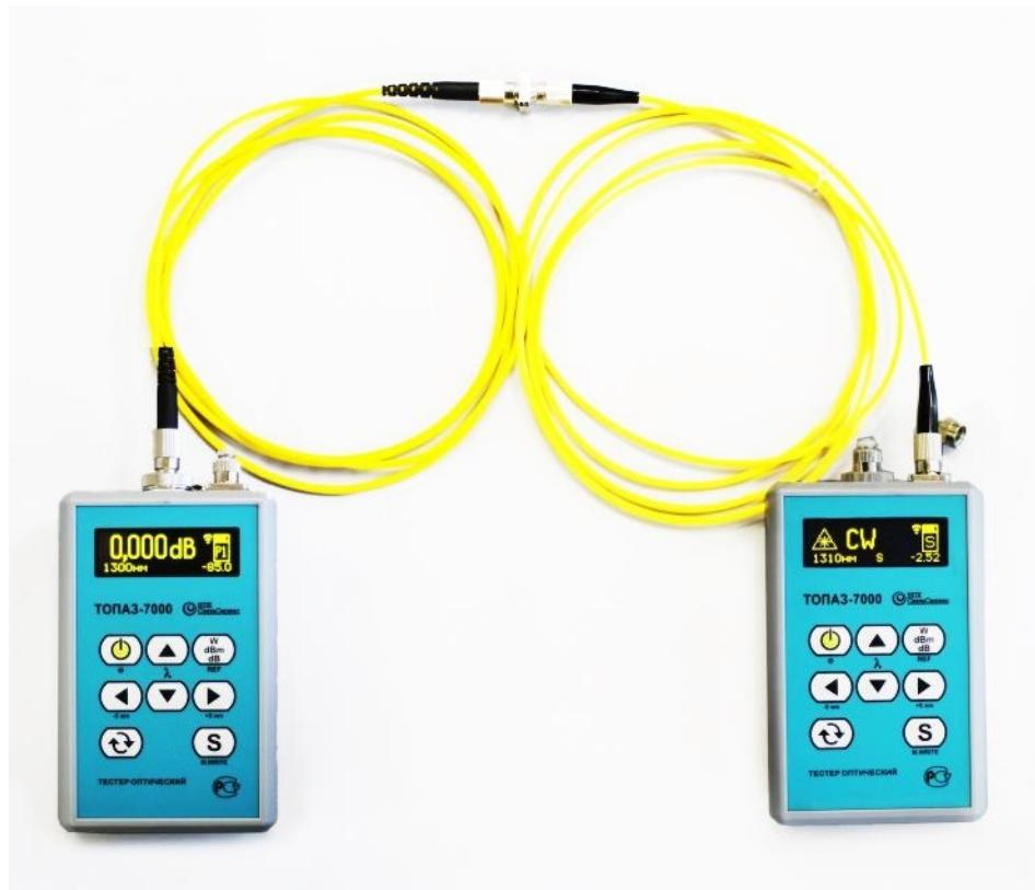
Рис.4.2. Измерение опорного уровня. Источник оптического сигнала на рисунке справа
