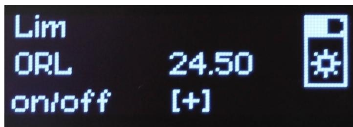
Рис.13.11. Установка порога по обратному отражению (ORL)
