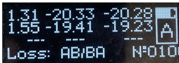
Рис.7.3. Результат измерения затухания
