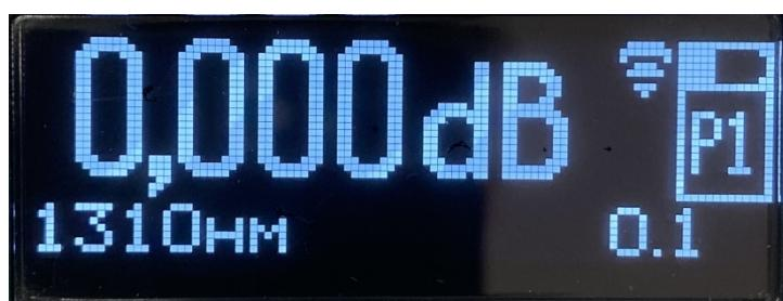
Рис. 4.3. Вид индикатора после установки опорного значения в режиме **P1**
