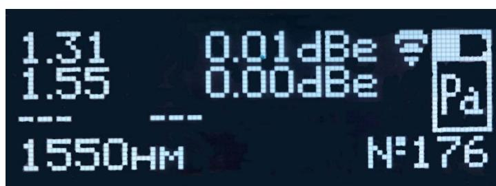
Рис.6.3. Режим Ра. Индикатор после установки отображаемых уровней источников.
