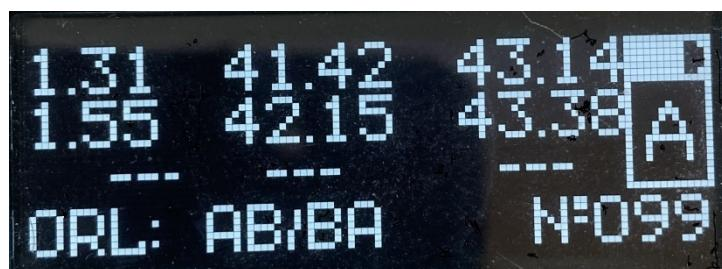
Рис.7.11. Результаты измерения обратного отражения
