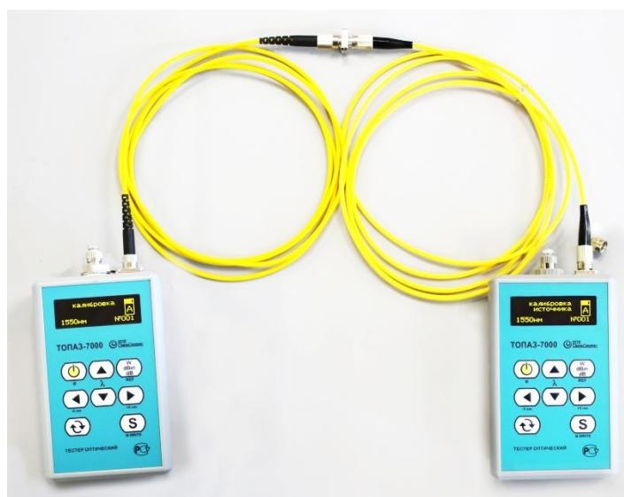
Рис.7.6. Калибровка приборов
