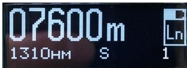
Рис.8.4. Режим Ln. Результат измерения длины при плохом вводе измерительного сигнала (второй результат – отражение в конце линии)
