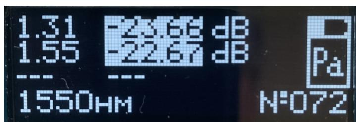
Рис.6.4. Индикация превышения пороговых значений
