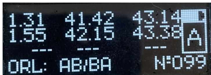
Рис.7.4. Результат измерения возвратных потерь
