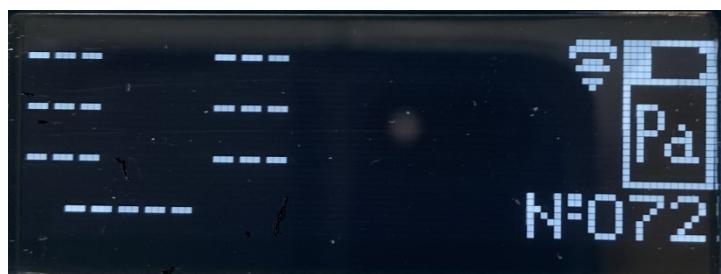
Рис.6.5. Индикация отсутствия сигнала на входе измерителя мощности или кода длины волны в сигнале.
