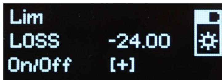
Рис.13.9. Установка порога по затуханию
