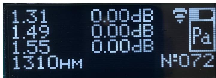
Рис.6.2. Режим Ра. Индикатор после установки опорных уровней.
