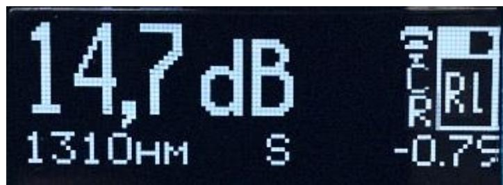
Рис.10.4. Результат компенсации затухания в тест-системе
