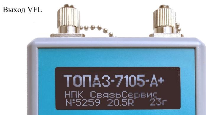
Рис.11.1. Верхняя часть прибора с опцией «Источник видимого излучения». Оптические разъемы и дисплей.
