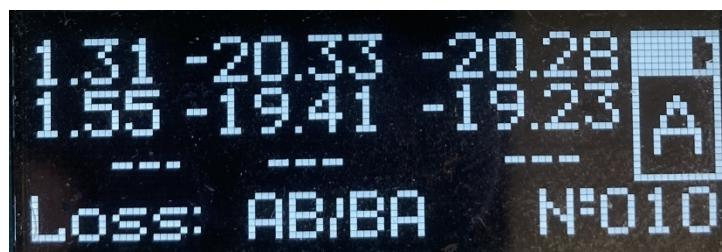
Рис. 7.10. Результаты измерения затухания
