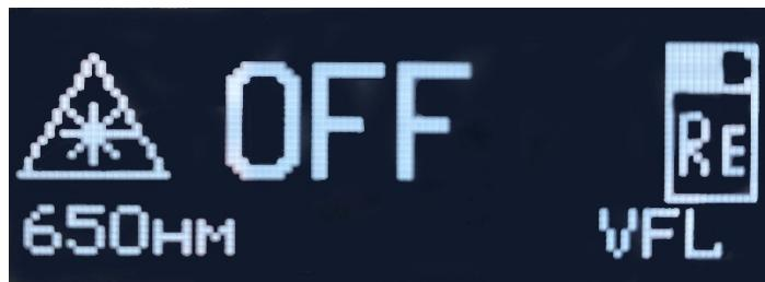
Рис.11.3. Режим Re - «Визуальный локатор». Источник видимого излучения выключен.
