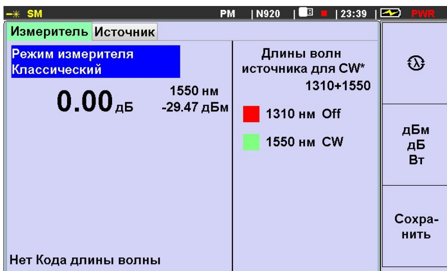
Рис.6.4. Установка эталонного уровня измерителя мощности
