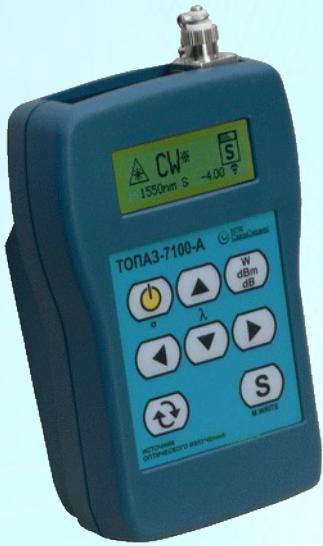
Оптические тестеры модельной группы (модификации) ТОПАЗ-7100X-AL серии «ТОПАЗ-7000» имеют пять режимов работы и могут выполнять функции измерителя оптической мощности, источника оптического излучения, измерителя обратного отражения (ORL) и измерителя длины линии или расстояния до обрыва. В режиме «Тестер-Автомат» позволяют с помощью пары тестеров выполнить двухсторонние измерения затухания линии, возвратных потерь и длины линии для 3-х длин волн за 20 секунд.
