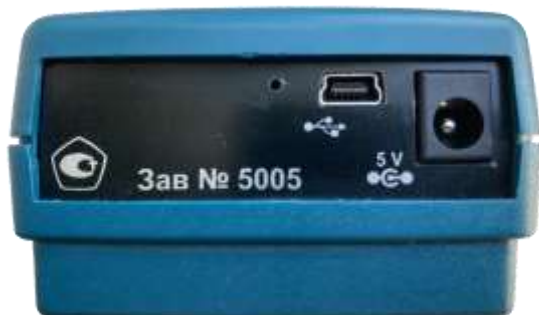
Рис. 2.1. Расположение коннектора «USB- mini» в приборах серии «Топаз-7000» версии 20.5
