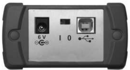
Рис.2.3. Расположение коннектора USB типа B в приборах серии «Топаз-7000-AR»
